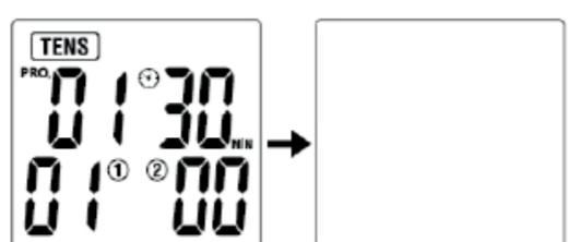
Het apparaat beschikt over een automatische lastherkenning bij alle ingestelde intensiteiten boven niveau 5. Wanneer de elektroden niet op de juiste wijze op de huid plakken of er zich een ander verbindingsprobleem voordoet, schakelt het apparaat automatisch naar niveau 0 en gaat het symbool **⑩** knipperen. Daarna schakelt het apparaat terug naar de stand-by modus.
